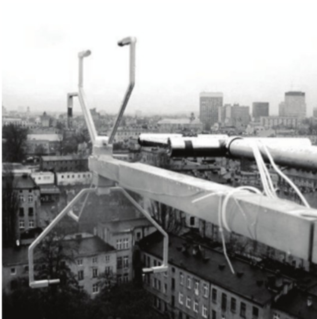
Rys. 3.2 Przykłady anemometrów akustycznych: ATI typ K o prostopadłych, nieprzecinających się osiach pomiarowych wykorzystywany do pomiarów przy ul. Lipowej (lewy rysunek) i R.M. Young 81000 o przecinających się osiach nieprostopadłych z umieszczoną obok głowicą analizatora gazowego Li-7500 (prawy rysunek).
