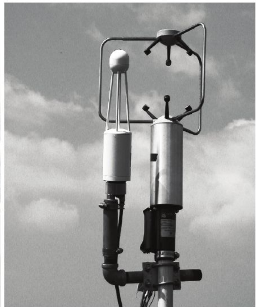
Rys. 3.2 Przykłady anemometrów akustycznych: ATI typ K o prostopadłych, nieprzecinających się osiach pomiarowych wykorzystywany do pomiarów przy ul. Lipowej (lewy rysunek) i R.M. Young 81000 o przecinających się osiach nieprostopadłych z umieszczoną obok głowicą analizatora gazowego Li-7500 (prawy rysunek).
