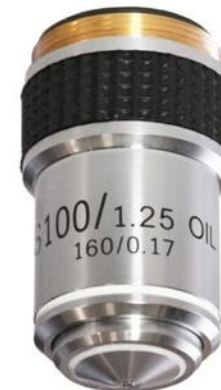
Rys. 4.10. Kodowanie informacji na obudowie obiektywu: 1 – korekcja, 2 – powiększenie, 3 – apertura numeryczna, 4 – symbol immersji, 5 – przeznaczenie, 6 – długość tubusa, 7 – grubość szkiełka nakrywkowego [2]
