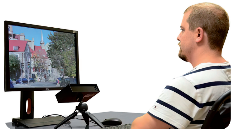
Ryc. 1. Podstawowe sposoby mocowania urządzeń POG i VOG: u góry po lewej urządzenie stacjonarne mocowane na głowie [3], u góry po prawej urządzenie mobilne mocowane na głowie [4], u dołu urządzenie przenośne bezkontaktowe [5]
